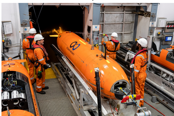
Fig. 15 - Récupération des robots sous-marins autonomes AUV (Autonomous Underwater Vehicle) Hugin 6000 à bord du Seabed Constructor – © Sébastien Chenal/Marine nationale/Défense.
