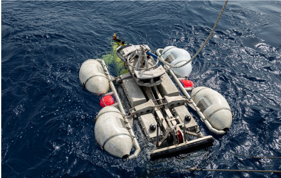
Fig. 12 - Mise à l'eau du drone Aster X de l'IFREMER à bord de l' Antea © Sébastien Chenal/Marine nationale/Défense
